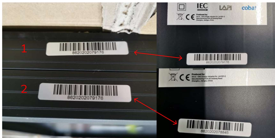
rys. 2 Zdublowany i błędnie przyklejony numer seryjny
