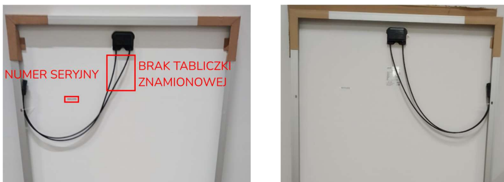
rys. 2 Zdublowany i błędnie przyklejony numer seryjny
