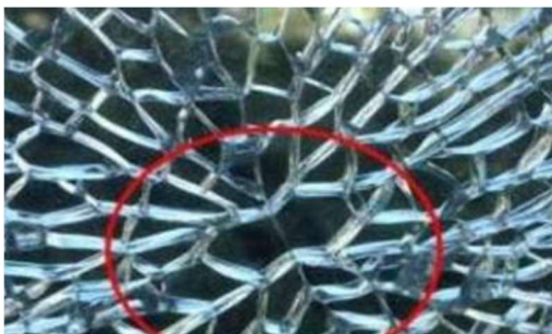
rys.1 Samoistne popękanie - punkt w kształcie „motyla”
