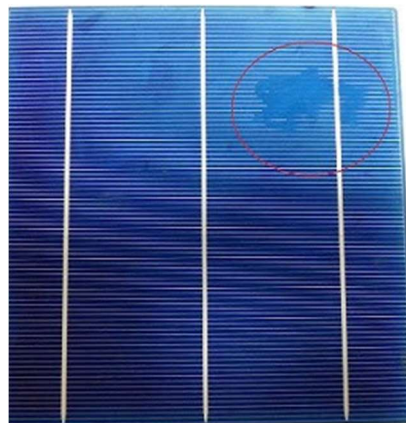
rys.3 Wada pod szkłem
