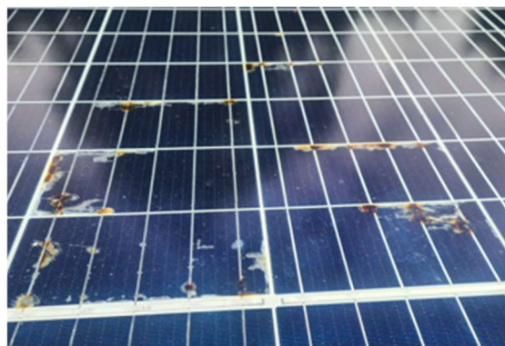
rys.2 Widoczne punktowe wypalenia
