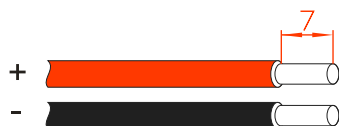
Rysunek 3-35 Schemat zdejmowania izolacji z okablowania wejściowego prądu stałego DC (jednostka miary: mm)
