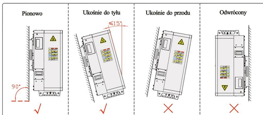
Rysunek 3-8 Ilustracja sposobu montażu
