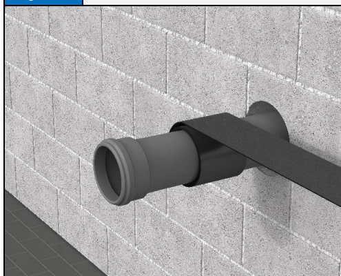
Rys.1 Rury palne w ścianie podatnej lub sztywnej o grubości A \geq 150 mm
