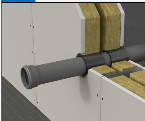
Rys.7 Rury palne w ścianie podatnej / sztywnej o grubości A \geq 125 mm
