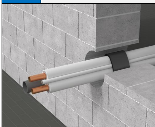
Rys.5 Wiązka rur do klimatyzacji z rurką do skroplin i kablem w ścianie sztywnej o grubości A \geq 150 mm
