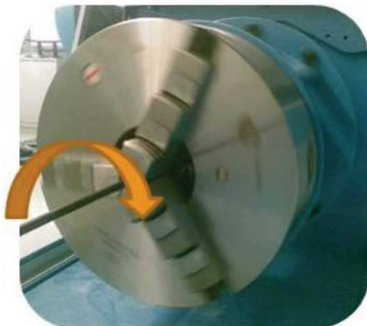
Rys: Cykliczne skręcanie: 50N ± 135° 100°/s
