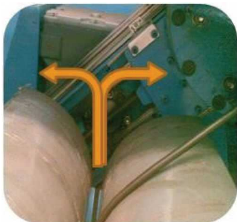
Rys: Odwrócone wyginanie: 100N ± 45° 160°/s
