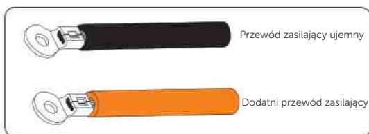
Rysunek 7-9 Wykonywanie przewodów zasilających
