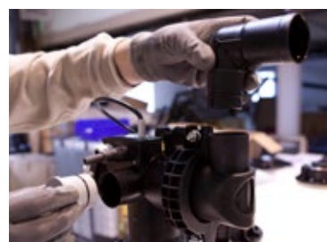
Etap 15: Kolanko odpowietrzające \varnothing 70\text{mm} 8 można regulować zależnie od życzenia
