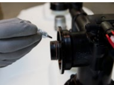
Etap 8: Lekko natłuszczyć smarem 6 pierścień samuszczelniający o przekroju okrągłym na jednostce podstawowej 1
