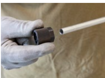
Etap 19: Zatyczkę z tworzywa sztucznego 13 włożyć z obu stron aluminiowego przewodu pobierającego Ø10 16
