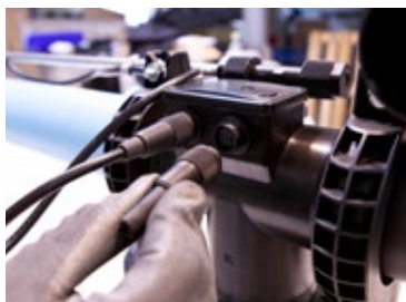
Etap 8: Gniazdo kabla 4 przymocować do ostatniego elementu rozbudowującego 14
