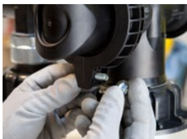
Etap 16: Skręcić ze sobą obejmy 9 za pomocą śrub M8x30 i nakrętki 10
