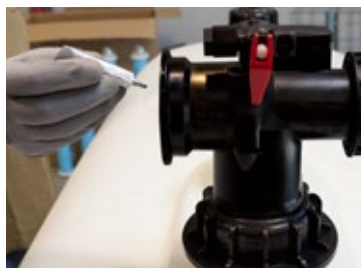
Etap 7: Lekko natłuszczyć 1 smarem pierścienia samoszczelniającego o przekroju okrągłym na jednostce podstawowej 6
