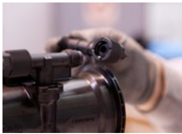
Etap 2: Kolanka pobierające 16 skręcić z gumowymi uszczelkami na elementach rozbudowujących 13
