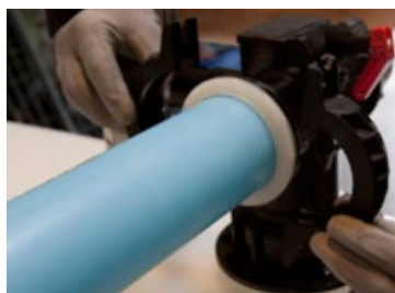
Etap 10: Zamocować 9 rurę rozbudowującą na jednostce podstawowej i na elemencie rozbudowującym 1 za pomocą obejm 14
