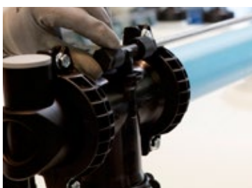
Etap 23: Zamocować korek gumowy 12 za pomocą zatyczki z tworzywa sztucznego 13
