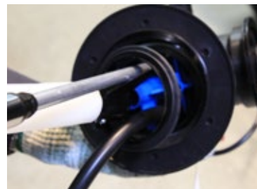
Etap 3: Wsunąć do oporu teleskopową rurkę piankową 2 do jednostki podstawowej 1
