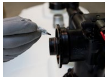
Etap 12: Lekko natłuszczyć smarem 6 pierścienia samoszczelniającego o przekroju okrągłym na jednostce podstawowej 1
