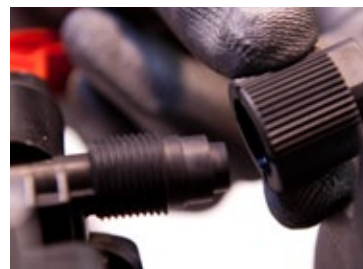
Etap 18: Zamocować gumową zatyczkę 11 przy pomocy korka z tworzywa sztucznego 13
