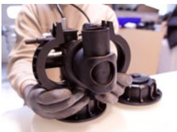
Etap 11: Zamocować kolanko odpowietrzające \varnothing 70\text{mm} 8 na jednostce podstawowej 1 przy pomocy obejmy 9
