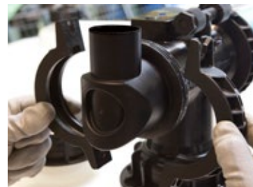
Etap 15: Kolanko odpowietrzające \varnothing 70\text{mm} 8 zamocować na elemencie rozbudowującym 14 przy pomocy obejm 9
