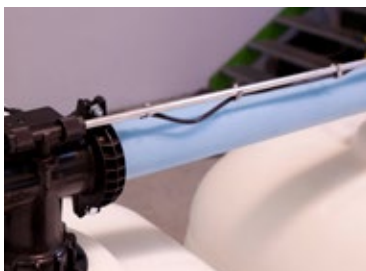
Etap 7: Kabel łączący 22 przy aluminiowym przewodzie pobierającym Ø10 16 przymocować za pomocą uchwyty do kabla 23
