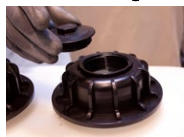
Etap 27: Odkręcić korek gwintowy z czwartej nakrętki
