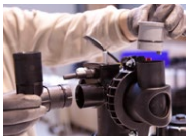
Etap 16: Kolanko odpowietrzające Ø42mm 7 można regulować zależnie od zyczenia.
