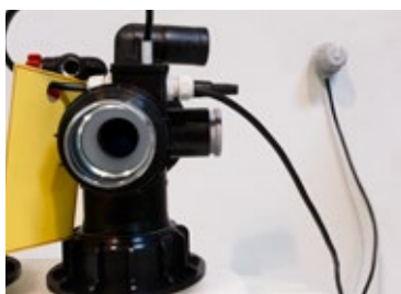
Etap 19: Odizolować przewody kabelkowe odporne na wilgoć 2x 1mm 2 i podłączyć do jednostki podstawowej 1 tak, jak na zdjęciu
