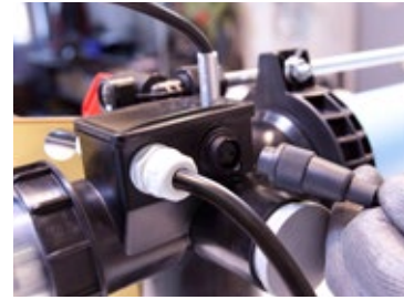
Etap 24: Podłączyć jednostkę podstawową 1 do elementu rozbudowującego 14 za pomocą kabla łączącego 22 , wszystkie dodatkowe elementy rozbudowujące muszą być ze sobą połączone kablem łączącym 22
