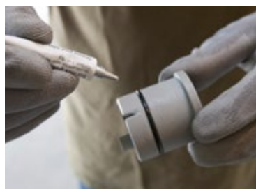
Etap 13: Lekko natłuszczyć 6 smarem zatyczkę odpowietrzającą \varnothing 42\text{mm} 11
