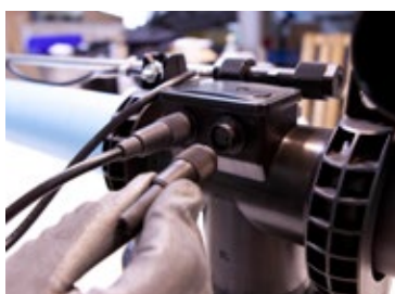
Etap 25: Przymocować gniazdo kablowe 4 do ostatniego elementu rozbudowującego 14
