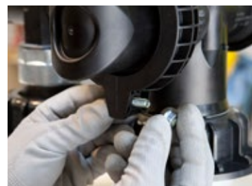
Etap 12: Skręcić ze sobą obejmę 9 za pomocą śruby M8x30 i nakrętki 10
