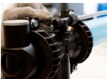
Etap 22: Na ostatnim elemencie rozbudowującym 14 uszczelnić przewód pobierający za pomocą gumowego korka 12
