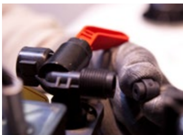
Etap 17: Przewód pobierający 1 uszczelnić za pomocą gumowej zatyczki 12
