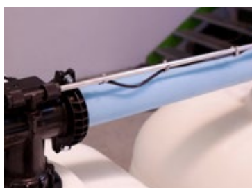
Etap 26: Zamocować kabel łączący 22 na aluminiowym przewodzie pobierającym Ø10 16 za pomocą uchwytu do kabla 23
