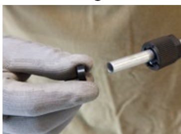
Etap 20: Wsunąć po obu stronach aluminiowego przewodu pobierającego Ø10 16 uszczelnienia do rurek pobierających 17
