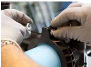
Etap 11: Skręcić obejmę 9 za pomocą śrub M8x30 10
