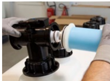
Etap 8: Wsunąć rurę rozbudowującą 15 do elementu rozbudowującego 14 do oporu
