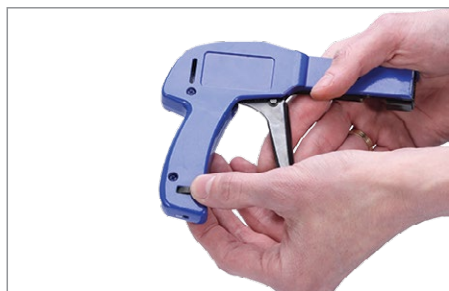
2.1 - Zaciąganie opasek kablowych za pomocą narzędzia - ustawić maksymalną siłę napinania opaski przez narzędzie w zależności od rozmiaru opaski
