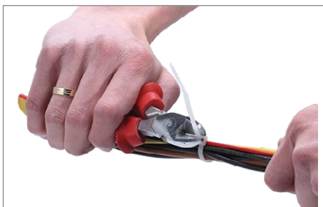
1.4 - Odciąć wystającą część opaski za pomocą szczypiec, zostawiając kilka mm jako zabezpieczenie
